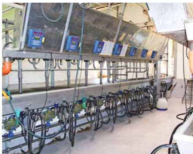
Dojírna Farmtec 2 x 7 s rychlým odchodem
