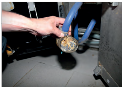
Vylepšení dojícího robotu v podobě odlučovače slámy si Martin Holub nemůže vynachválit, neboť se nezanášejí trysky
