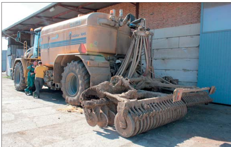
Terra Gator, který zapravuje kejdu a digestát
