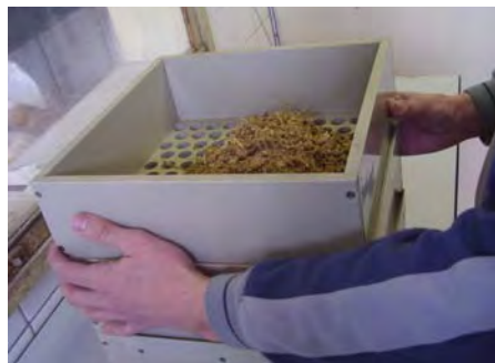
Třepáním řezanky v PSPS separátoru se pomocí síty s oky 19 a 8 mm oddělí dlouhé částice řezanky od zbytku, který projde sítí
